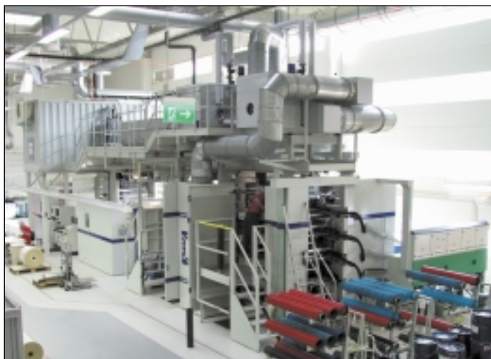
Herzstück der neuen Produktionsstätte ist die drei Millionen Euro teure neue Zentralzylinder-Flexodruckmaschine. Sie wiegt 80 Tonnen, ist 23 m lang und sieben m hoch. Fotos: A. Köckert
